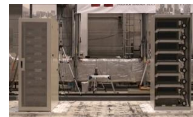
大型三軸振動台による耐震試験
